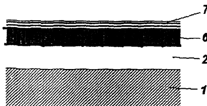
Рис.4.3. Схема капитальных жестких дорожных одежд 1 – грунт земляного полотна; 2 – дренирующий песчаный слой; 3 – «Геогеб» с песчаным наполнителем, 4 – геотекстиль, 5 – бетонные плиты; 6 – «Геогеб» с ячейками, заполненными бетоном, 7 – асфальтобетонное покрытие
