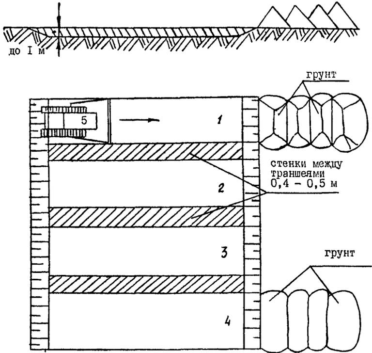
Траншейно-полосная схема разработки и перемещения грунта
