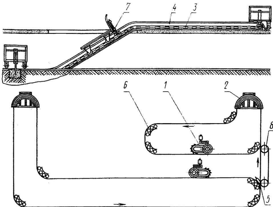
1—привод; 2—натяжное устройство; 3—тяговая цепь; 4—ходовой путь; 5—стрелочный перевод; 6—поворотное устройство; 7—грузовая тележка; 8—передающее устройство
