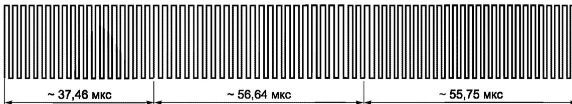
Рисунок 17 — Конец кадра при использовании двух поднесущих
