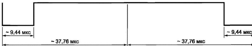
Рисунок 7 — Начало кадра при способе кодирования «1 из 256»
