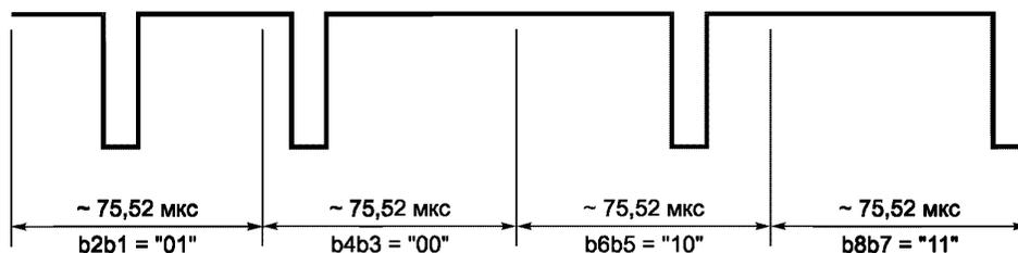
Рисунок 6 — Пример кодирования способом «1 из 4»
