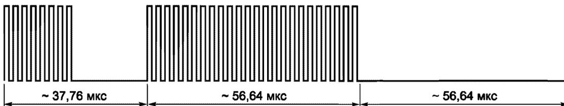
Рисунок 16 — Конец кадра при использовании одной поднесущей
