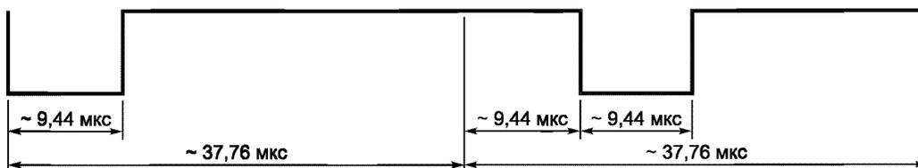
Рисунок 8 — Начало кадра при способе кодирования «1 из 4»
