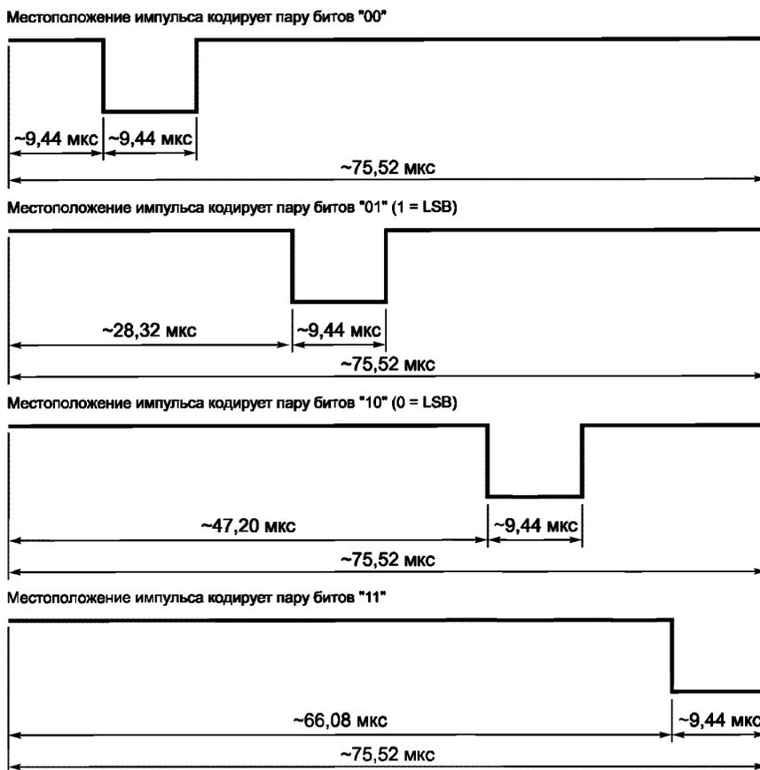
Рисунок 5 — Способ кодирования «1 из 4»
