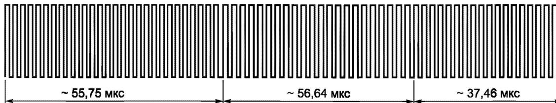
Рисунок 15 — Начало кадра при использовании двух поднесущих
