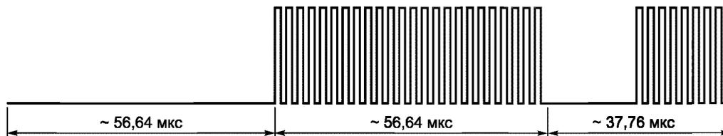
Рисунок 14 — Начало кадра при использовании одной поднесущей
