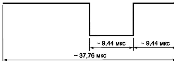
Рисунок 9 — Конец кадра при любом способе кодирования
