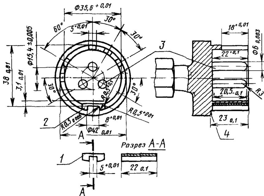
1—съемная вставка для контроля розеток 32А, 2—съемная вставка для
