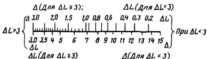
В случае установки группы одинаковых машин в окружении малошумного оборудования, значения, рассчитанные по приведенной выше формуле, следует уменьшить на величину  $\Delta$ , найденную по номограмме (см. чертеж), при известной величине  $L$  уменьшения шума за счет установки в цехе малошумного оборудования, найденной по уравнению
