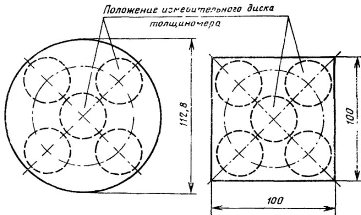
1.4.4. Линейные размеры элементарной пробы измеряют с погрешностью не более 0,5 мм с изнаночной стороны в трех местах центральной части пробы на расстоянии не менее 20 мм от краев.
