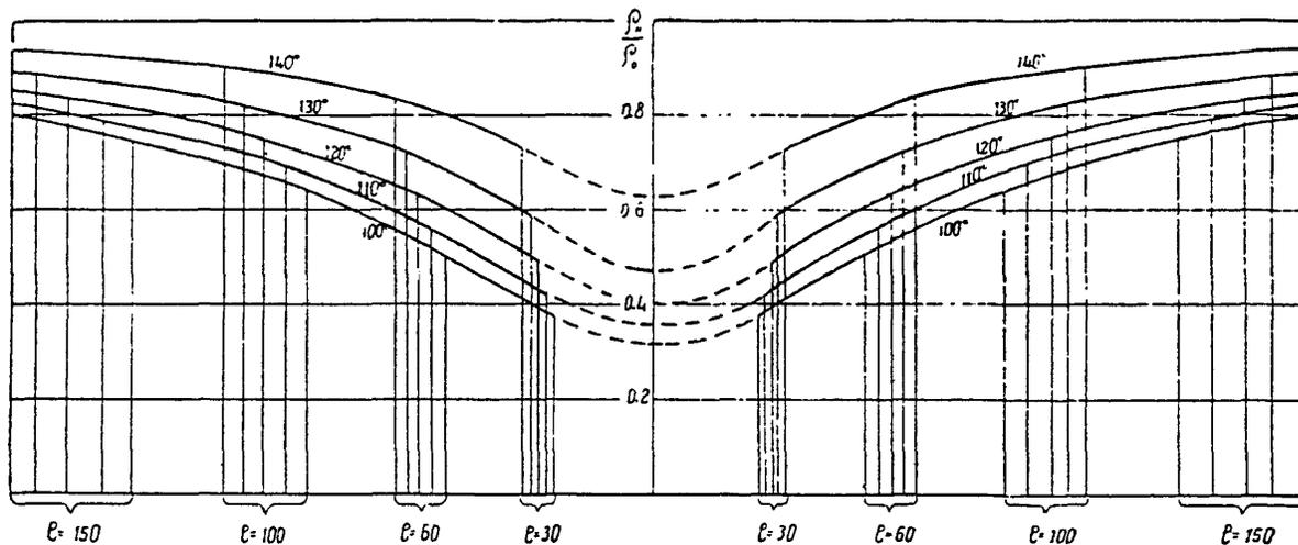
Рис. 12. Палетки  $\rho_k / \rho_o$  комбинированного профилирования, рассчитанные для различных значений  $\alpha$  у гребня хребта:  $140^\circ, 130^\circ, 120^\circ, 110^\circ$  и  $100^\circ$ ;  $AO=OB=340$  м,  $MN=24$  м. Электропрофиль направлен нормально к оси хребта.
