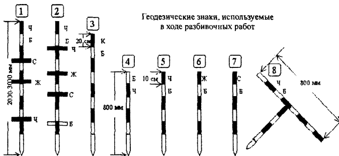
Рис. 1. Геодезические знаки, используемые в ходе разбивочных работ:
