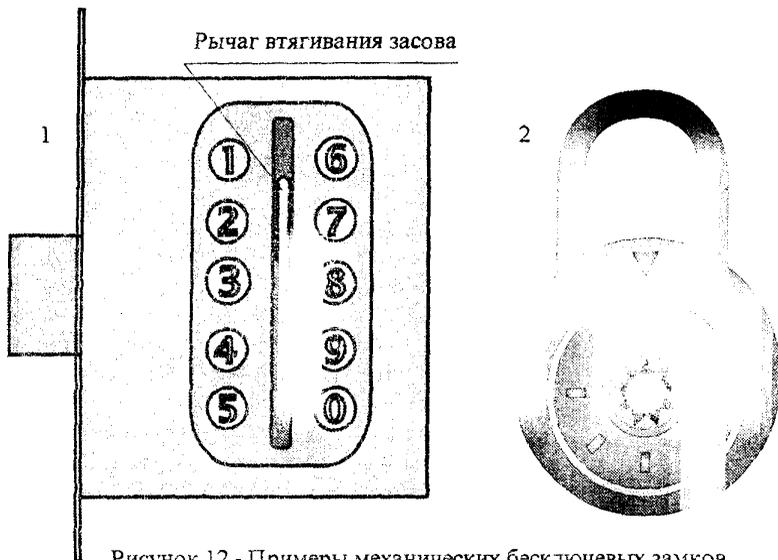
Рисунок 12 - Примеры механических бесключевых замков
