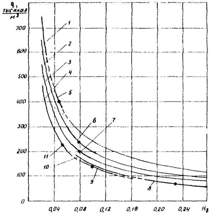
Зависимость удельного расхода тепла  $q$  от коэффициента загрузки пропарочных камер при различных модулях поверхности камер, [14]
