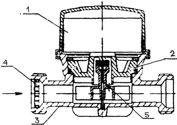
1 - поворачивающийся счетный механизм; 2 - пластина отделяющая счетный механизм от водяной камеры; 3 - корпус; 4 - фильтр; 5 - тело обтекания.
