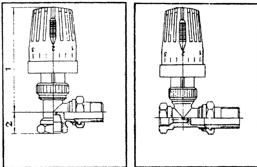
В общем виде радиаторный термостат работает следующим образом. При повышении температуры в помещении выше заданной управляющая часть радиаторного термостата вырабатывает сигнал на закрытие клапана, который передается выходным звеном термостатической головки на входное звено регулирующего клапана.
