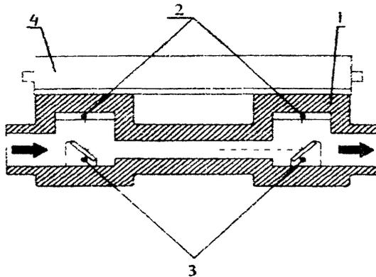
1 - корпус; 2 - преобразователи ультразвука; 3 - отражатели; 4 - электронный блок
