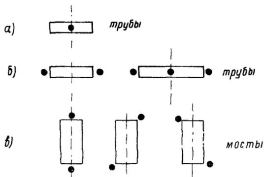
Рис 1 Схема расположения выработок при инженерно-геологическом обследовании мест устройства мостов искусственных сооружений.
