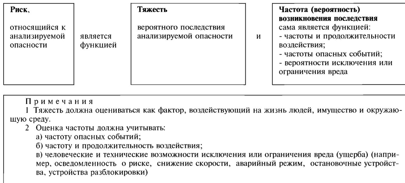
Рисунок 2 — Схема представления определения рисков
