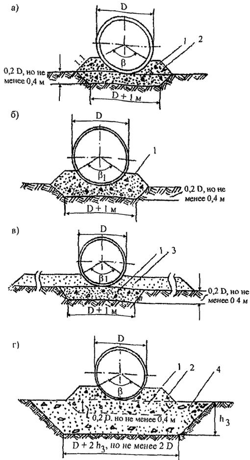
**Рис. 2. Конструкция основания под трубами:**
