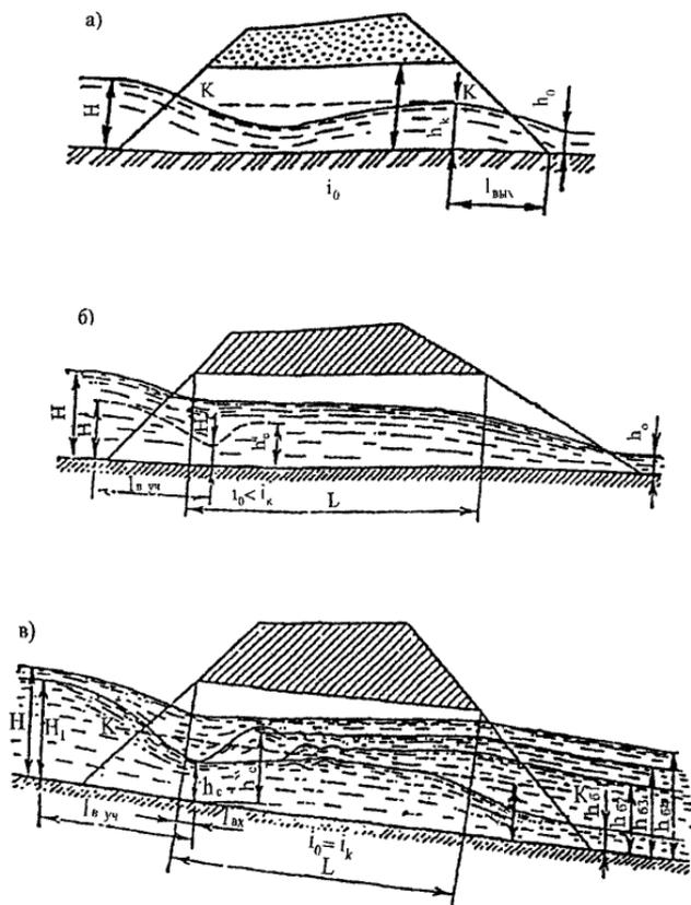
**Рис. П.3.1. Схема протекания воды в равнинной трубе при безнапорном режиме: а – «короткая»; б – «длинная»; в – «незатопленная» ( $h_{62}, h_{63}$ ) и «затоплены» с нижнего бьефа ( $h_{64}$ ).**
