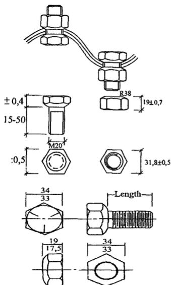
**Рис.П.2.2. Болты и гайки зарубежных фирм**
