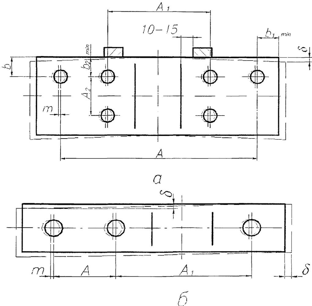
а – полухомуты для вертикальных трубопроводов; б – полухомуты для горизонтальных трубопроводов
