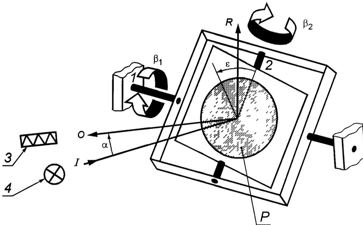
*I* — первая ось *2* — вторая ось *3* — фотометрическая головка *4* — источник света
