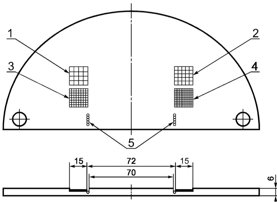
1—4 — проволочная сетка из нержавеющей стали: 1 — шаг сетки 100 микрон, диаметр проволоки 80 микрон; 2 — шаг сетки 80 микрон, диаметр проволоки 50 микрон; 3 — шаг сетки 63 микрона, диаметр проволоки 40 микрон; 4 — шаг сетки 40 микрон, диаметр проволоки 32 микрона; 5 — цепочка из шариков диаметром 2 мм для проверки положения пучка излучения
