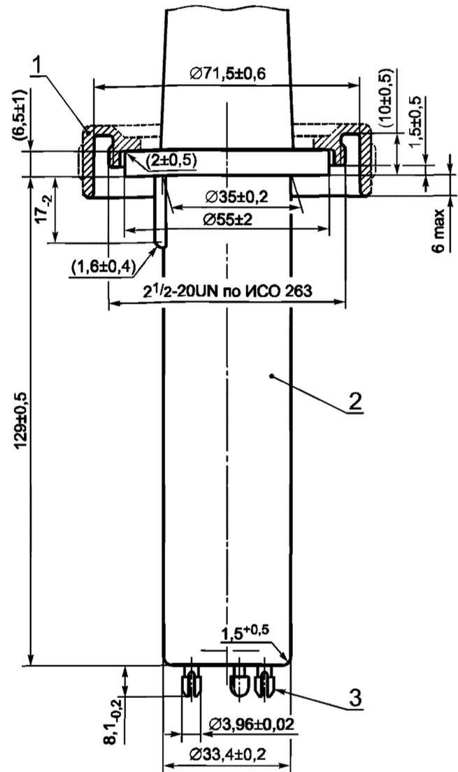
1 — кольцевая гайка; 2 — наконечник; 3 — контактные штыри
