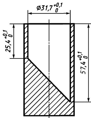
Рисунок Б.1 — Усеченный цилиндр
