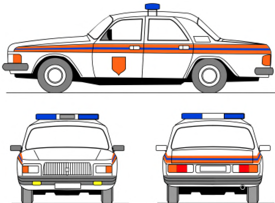
Рисунок А.27 — Цветографические схемы автомобилей служб предотвращения и помощи при чрезвычайных ситуациях и гражданской обороны
