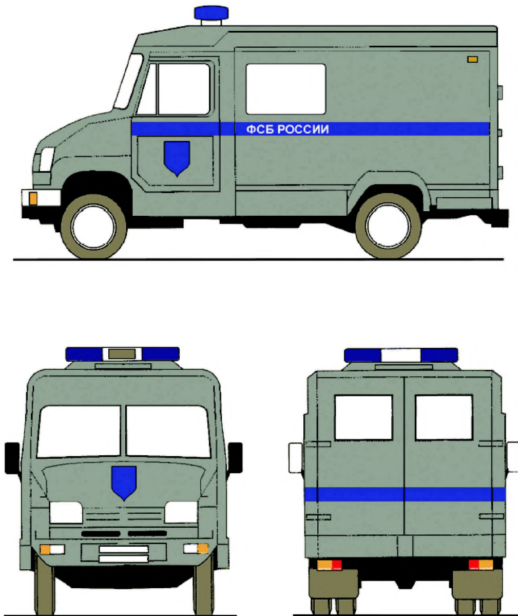
Рисунок А.40 — Цветографические схемы автомобилей органов федеральной службы безопасности, используемых для проведения неотложных действий по разминированию
