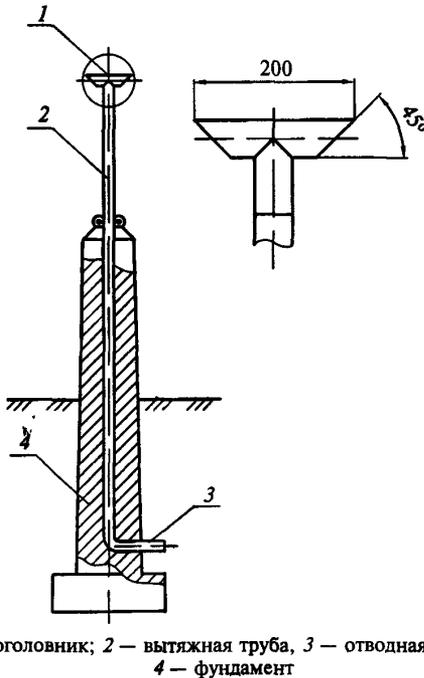
1 — оголовок; 2 — вытяжная труба, 3 — отводная труба,
