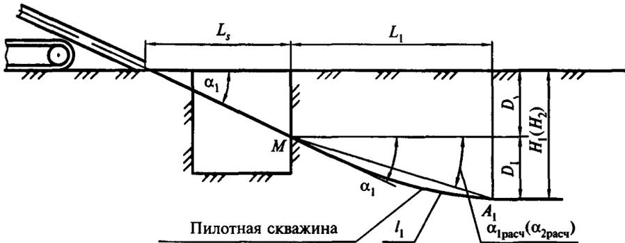
Рисунок Л.2 — Схема забурирования пилотной скважины
