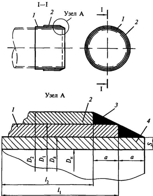
1 — внутреннее кольцо, 2 — наружное кольцо, 3 — наплавка, 4 — прокладываемый футляр
