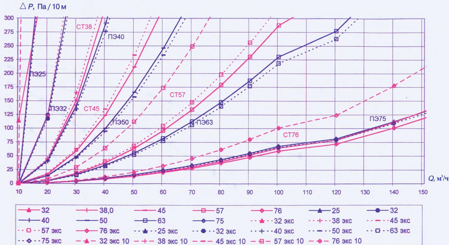
Удельные потери давления для стальных и полиэтиленовых труб (новых и бывших в эксплуатации) среднего давления
