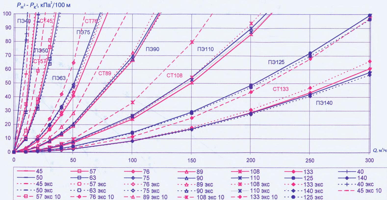
Удельные потери давления для стальных и полиэтиленовых труб (новых и бывших в эксплуатации) высокого давления
