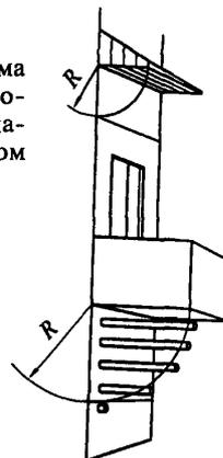
Не рекомендуется предусматривать выход дымового канала через наружную стену в проезды (арки), туннели, подземные переходы и т.п.
