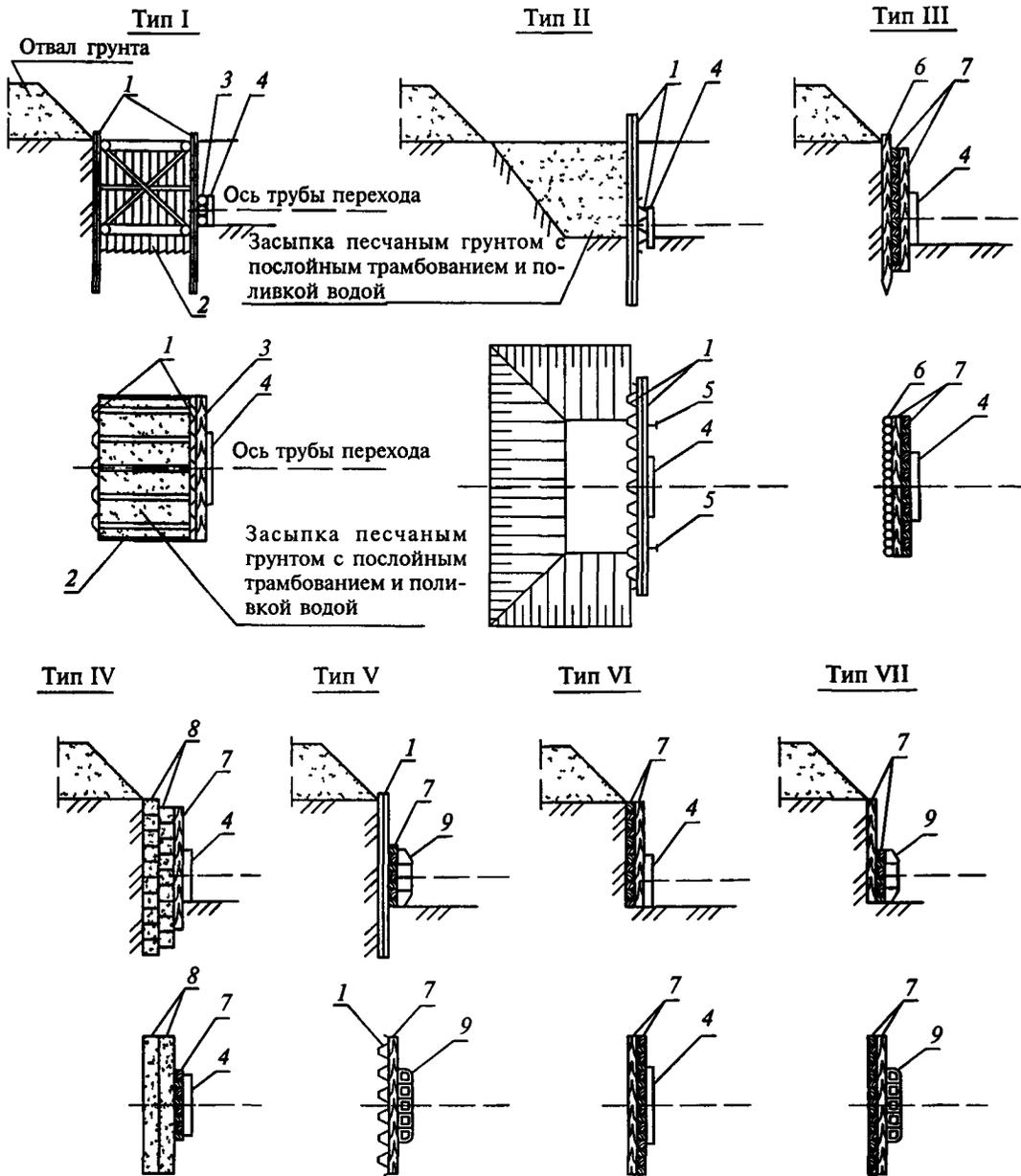
Тип I и II — для слабых грунтов ( $\varphi \leq 18^\circ$ ), тип III и IV — для средних грунтов ( $\varphi \leq 18-30^\circ$ ), тип V, VI и VII — для прочных грунтов ( $\varphi > 30^\circ$ )
