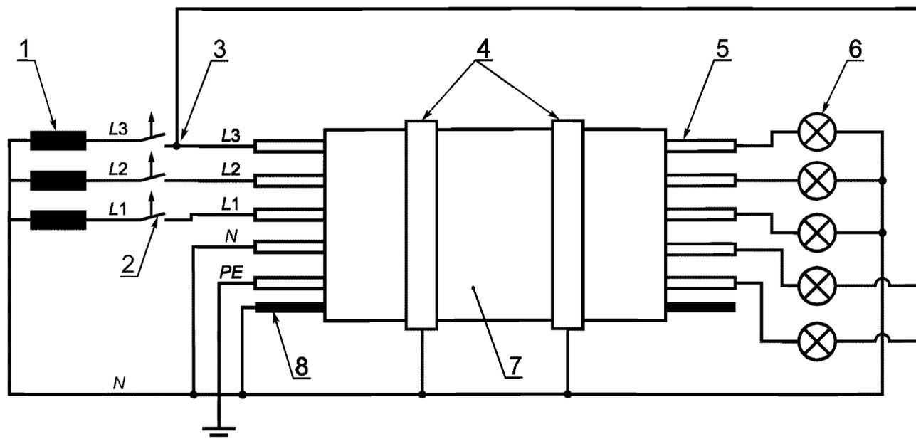
1 — трансформатор; 2 — плавкий предохранитель (2 А); 3 — подсоединение к фазе (или  $L1$ , или  $L2$ ); 4 — поддерживающие кольца; 5 — испытуемая жила или группа жил; 6 — нагрузочный индикаторный прибор (например, лампа); 7 — образец; 8 — металлический экран (если имеется);  $L1$ ,  $L2$ ,  $L3$  — фазные жилы ( $L2$ ,  $L3$ , если имеются);  $N$  — нейтральная жила (если имеется);  $PE$  — защитная жила (если имеется)
