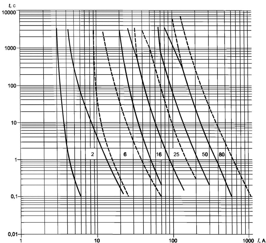
Рисунок А.1 — Время-токовые зоны для плавкого предохранителя
