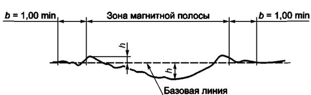
Рисунок 8 — Вогнутый профиль полосы
