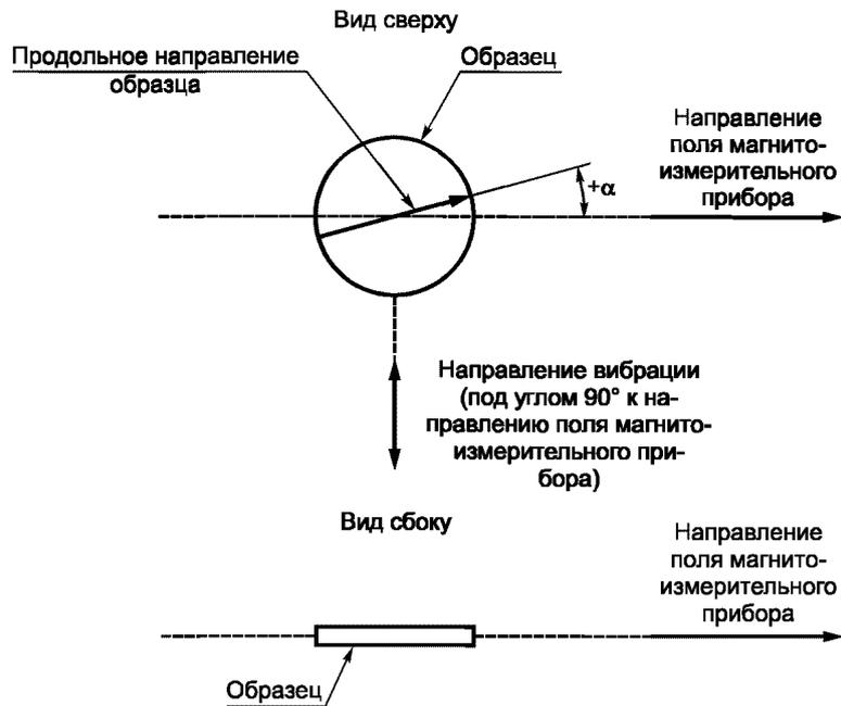
Рисунок 22 — Положение образца при измерении зависимости коэффициента прямоугольности от угла  $\alpha$  в плоскости образца
