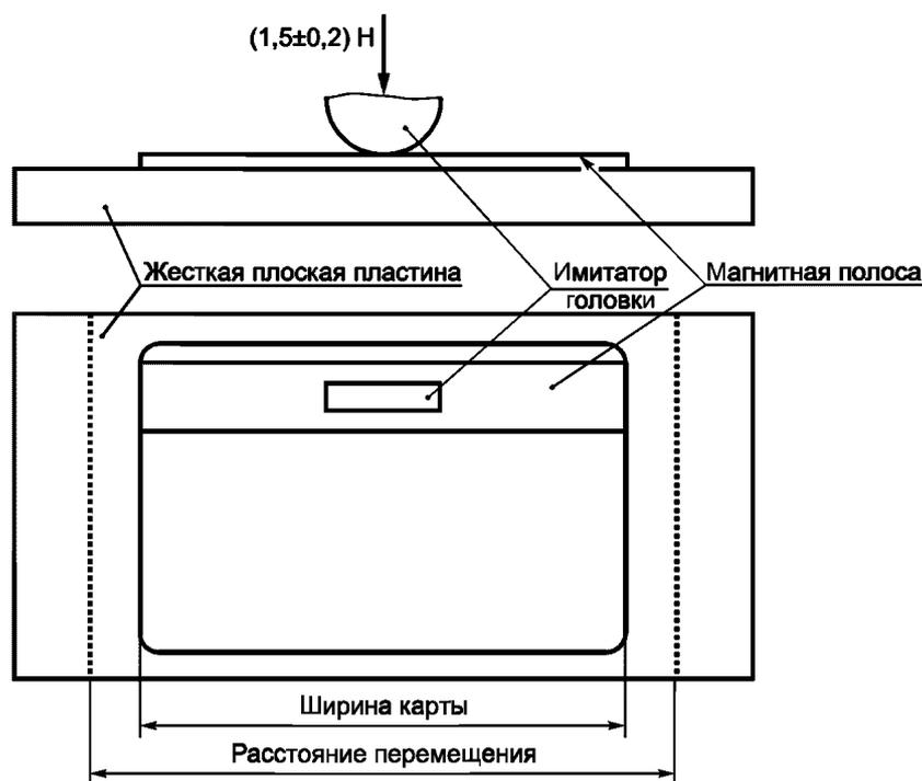
Рисунок 11 — Имитатор головки и магнитная полоса
