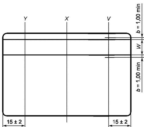
Рисунок 5 — Положение линий измерений профиля магнитной полосы
