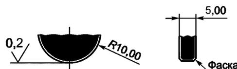
Рисунок 10 — Размеры контактной поверхности имитатора головки
