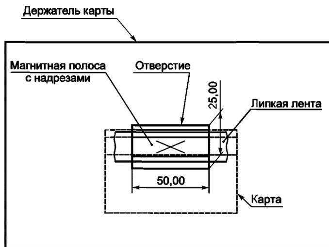
Рисунок 18 — Схема испытания магнитной полосы на адгезию
