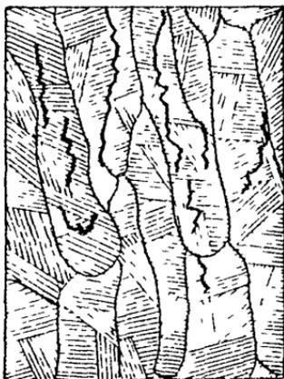
Рис. 4. Кристаллизационные трещины в металле шва. X100
