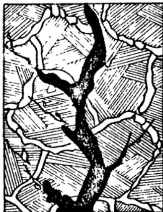
Рис. 8. Трещины, обусловленные действием ударных нагрузок. X100
