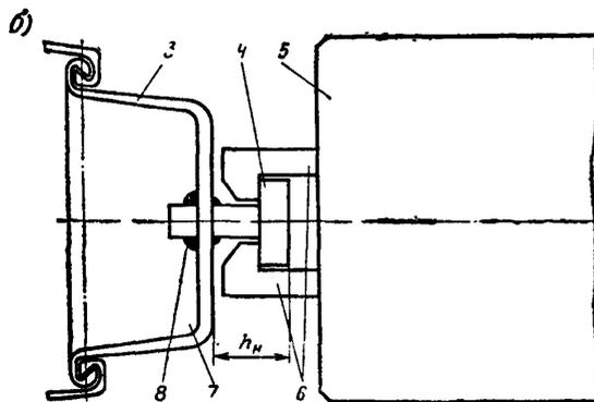
Рис. 8. Варианты соединения анкерной плиты со шпунтовой стенкой:
