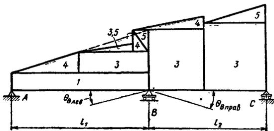
Рис. 3. Разбивка эпюры нагрузки на простейшие фигуры (цифры обозначают порядковый номер схемы нагрузки в табл. 1)
