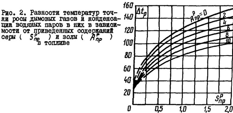
Рис. 2. Разности температур точки росы дымовых газов и конденсации водяных паров в них в зависимости от приведенных содержаний серы ( $S^p$ ) и золы ( $A^p$ ) в топливе
