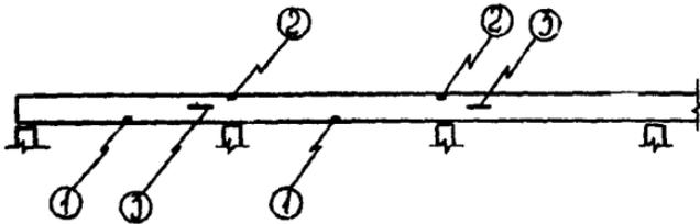
Рис. 2. Места вскрытий арматуры в многопролетной балке:
