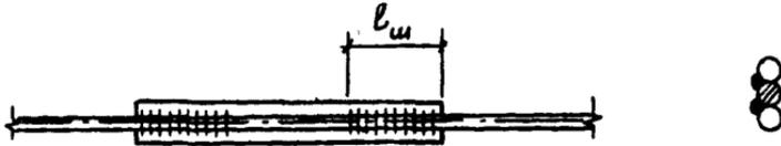
Рис. 6. Усиление стержня арматуры в конструкции
