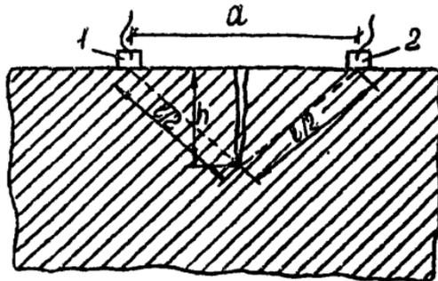
Рис. 1. Определение глубины трещины в конструкции:
