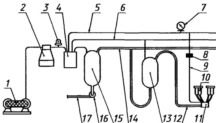
1 — вакуумный насос, 2 — вакуумный сосуд, 3 — регулятор, 4 — санитарный сифон, 5 — воздушный трубопровод (пульсаторы), 6 — воздушный трубопровод (молочный вакуум), 7 — вакуумметр, 8 — вибратор, 9 — длинная пульсирующая трубка, 10 — стаканы для сосков, 11 — держатель, 12 — длинная трубка для молока, 13 — емкость, снабженная регистрирующим прибором, 14 — подающий трубопровод, 15 — ресивер, 16 — насос сливного устройства молока, 17 — подающий трубопровод
