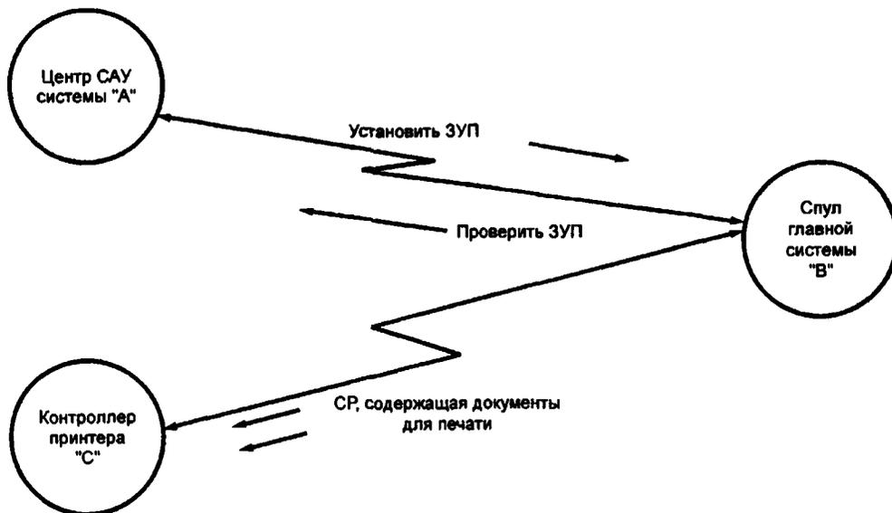
Рисунок С.3 — Пример обработки ЗУП третьей стороной
