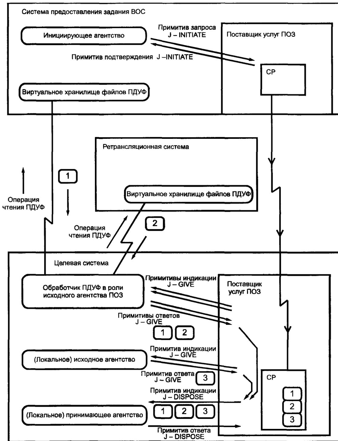
Рисунок С.6 — Обработка подзадания с поздним соединением
