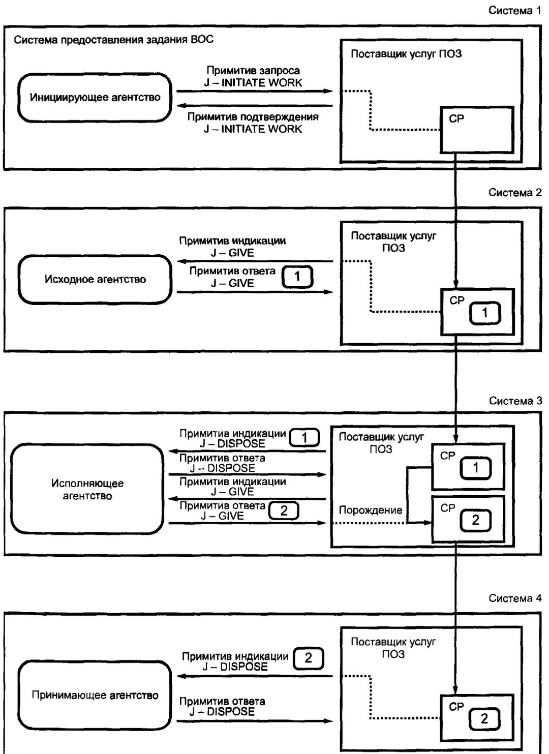
Рисунок С.8 — Пример потока обработки для уровня исполнения ЗАВЕРШЕНИЕ
