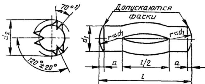
1) Угол  $70^\circ$  применяется только на штифтах, изготовленных из стали, указанной в таблице 2. Угол насечки может изменяться в зависимости от пластичности материала.
