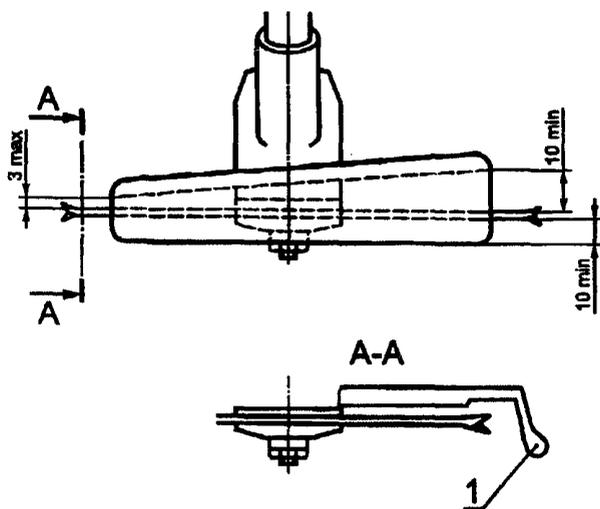
1 — закрепленная кромка для предотвращения зацепления
