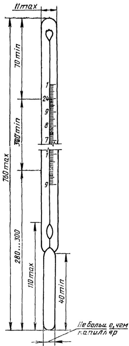
Рисунок 1 — Термометр палочный калориметрический
