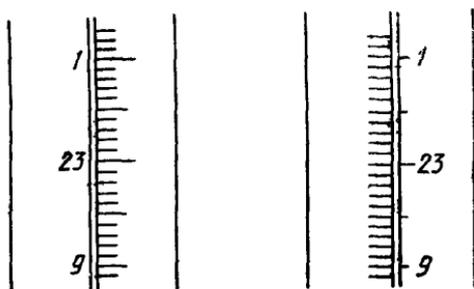
Рисунок 2 — Различные способы градуировки и оцифровки
