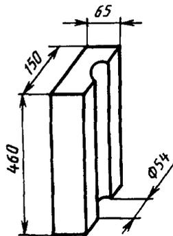
Рисунок 31 — Изделие с контрольным отверстием номер 88
