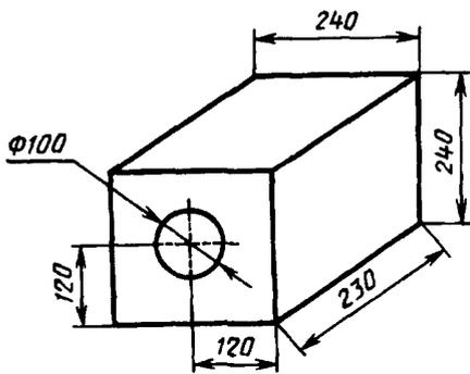
Рисунок 30 — Изделие с контрольным отверстием номер 87
