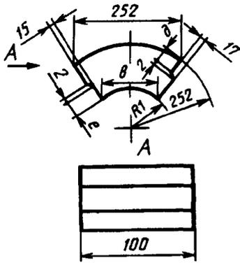
Рисунок 25— Секторное изделие номеров 66, 68
