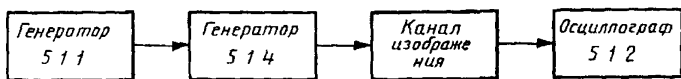
Рисунок 13 — Структурная схема измерений временного положения синхронизации, содержания строки и местоположения пакетов цифровых данных сигнала телетекста
