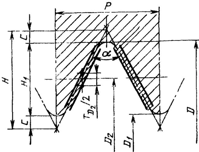
$D$  — наружный диаметр;  $D_1$  — внутренний диаметр;  $D_2$  — средний диаметр;  $P$  — шаг резьбы;  $\alpha$  — угол профиля резьбы;  $H$  — высота исходного треугольника;  $T_{D_1}$  — допуск на внутренний диаметр;  $T_{D_2}$  — допуск на средний диаметр;  $H_1$  — рабочая высота профиля;  $C, \frac{H}{6}$  — срез вершин и впадин резьбы.
