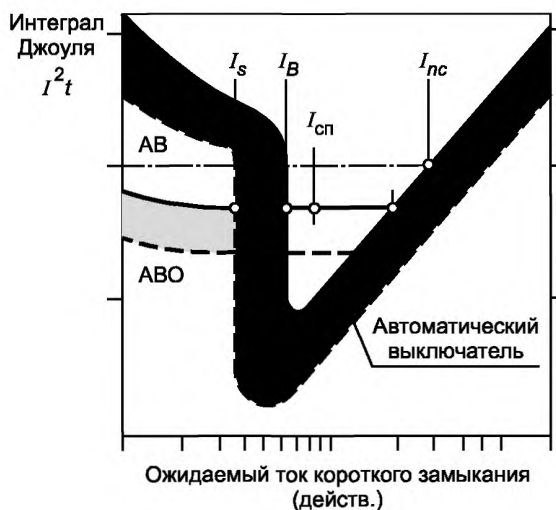
Рисунок Ф.1 — АВО с тепловым расцепителем, резервной защитой, осуществляемой автоматическим выключателем с теплоэлектромагнитным расцепителем
