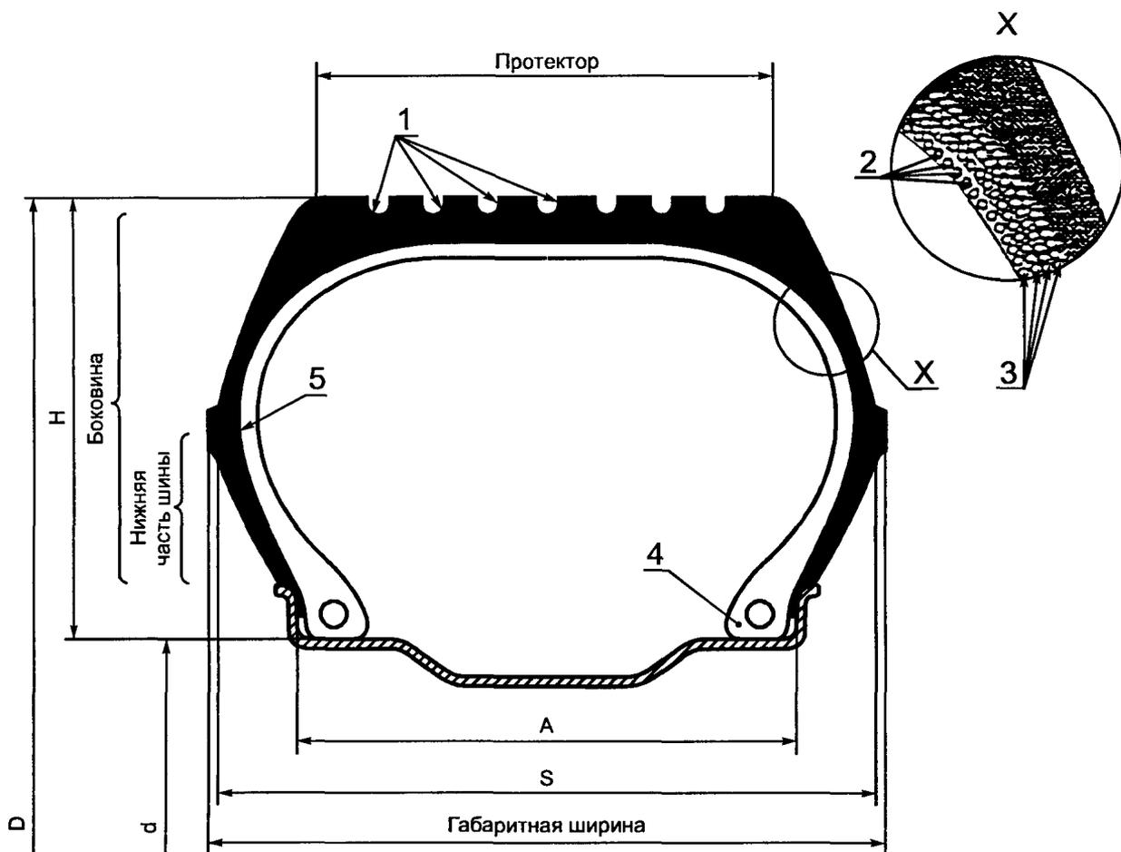
$D$  — наружный диаметр;  $d$  — номинальный диаметр обода;  $H$  — высота профиля;  $A$  — ширина обода;  $s$  — ширина профиля; 1 — канавки протектора; 2 — корд; 3 — слой; 4 — борт; 5 — каркас
