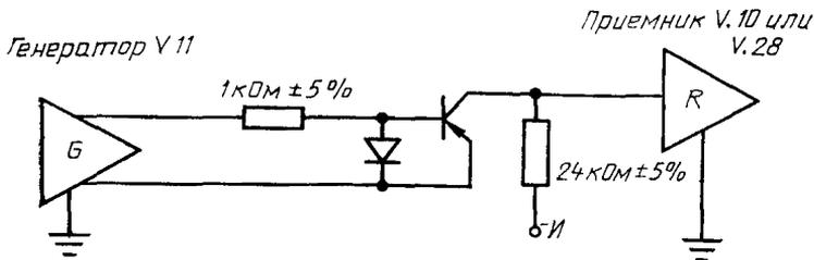
Рисунок D.1 — L-образный удлинитель для защиты приемника V.10 или V.28
