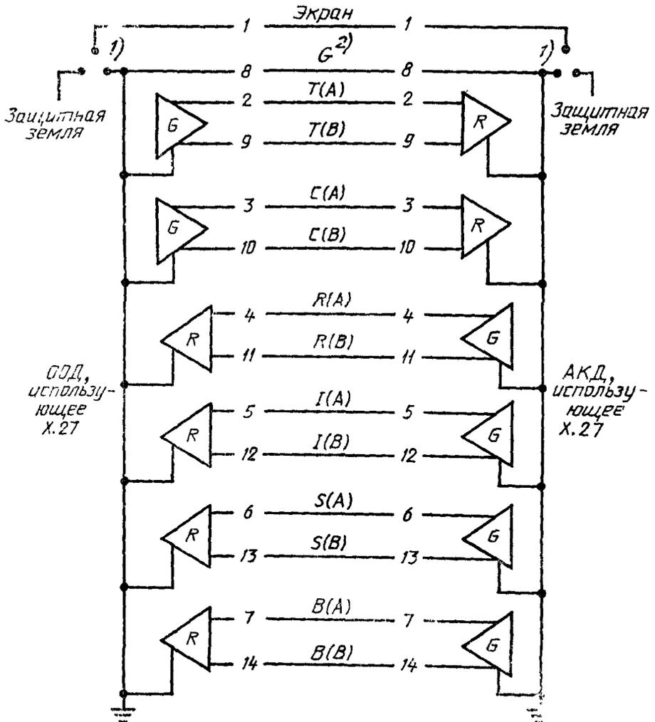
1) Контакт 1 предназначен для соединения экранов между спаренными частями экранированного интерфейсного кабеля. Экран может быть подсоединен либо к защитной земле, либо к сигнальной земле на стороне ООД или АКД или на обеих сторонах в соответствии с национальными правилами.
