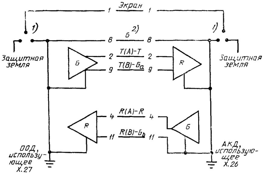
1) Контакт предназначен для соединения экранов между спаренными частями экранированного интерфейсного кабеля. Экран может быть подсоединен либо к защитной земле, либо к сигнальной земле на стороне ООД или на обеих сторонах в соответствии с национальными правилами.
