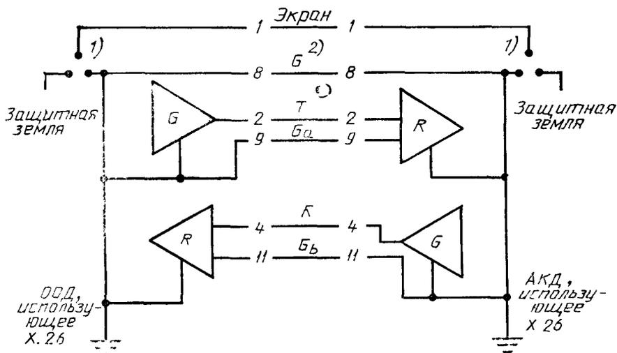
1) Контакт 1 предназначен для соединения экранов между спаренными частями экранированного интерфейсного кабеля. Экран может быть подсоединен либо к защитной земле, либо к сигнальной земле на стороне ООД или АКД, или на обеих сторонах в соответствии с национальными правилами.
