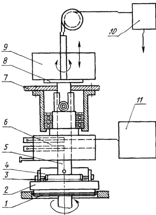
Узел истирания состоит из сменной платформы 2 для закрепления образца, истирателей 3 и динамометра 11 для измерения силы трения или скольжения.
