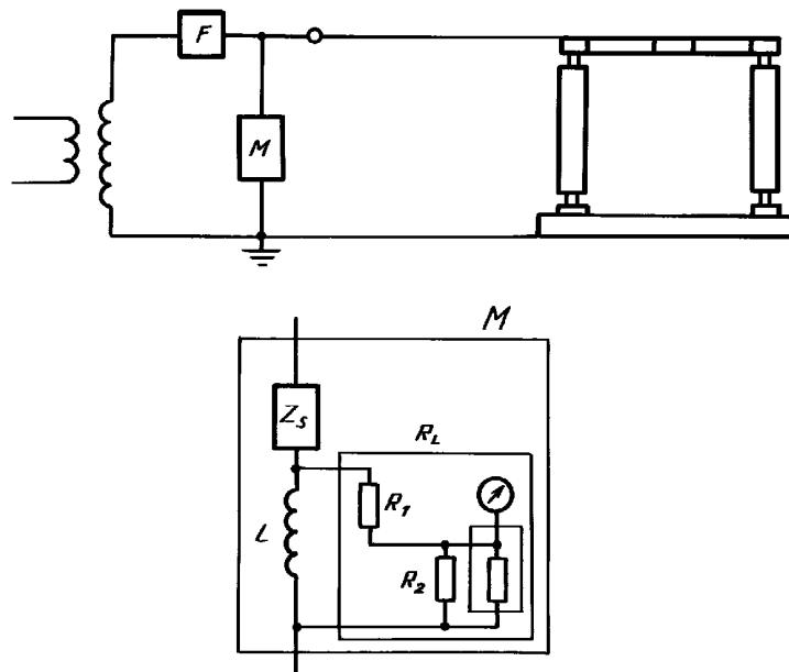
*F — фильтр; M — измерительный блок;  $R_L$  — эквивалентное сопротивление  $R_1$ , соединенное последовательно в комбинации с сопротивлением  $R_2$ , соединенным параллельно с эквивалентным сопротивлением измерительной установки;  $Z_s$  — может быть конденсатором или цепью, состоящей из конденсатора и индуктивной катушки, соединенных последовательно; L — используется для шунтирования токов промышленной частоты и для компенсирования паразитной емкости при измерительной частоте*
