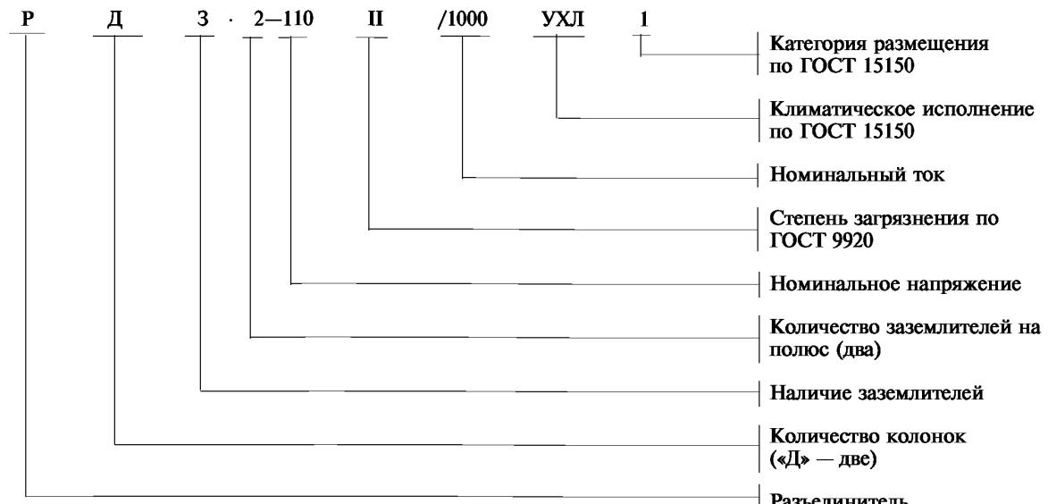
1.3.4. Условное обозначение отдельно стоящего заземлителя устанавливают по следующей структуре:
