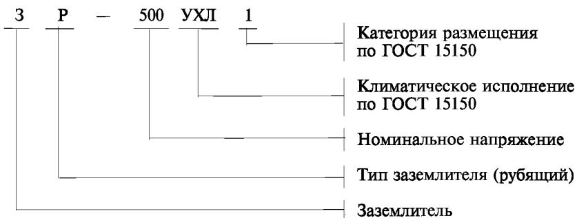
1.3.5. Условное обозначение привода устанавливают по следующей структуре:
