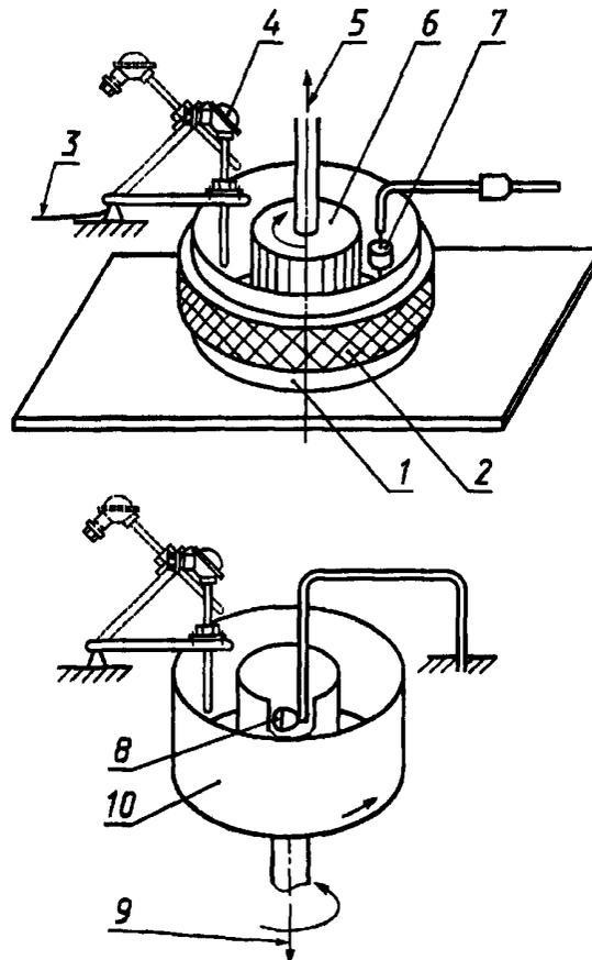
1 — сосуд; 2 — нагревательный элемент; 3 — поворотный рычаг; 4 — ТС; 5 — на привод с переменной скоростью; 6 — вращающийся барабан; 7 — нагреватель; 8 — инфракрасная лампа; 9 — на привод с переменной скоростью; 10 — вращающийся сосуд
