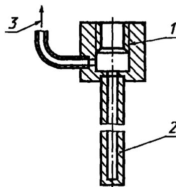
1 — резьба под сальник; 2 — трубка из нержавеющей стали; 3 — к газовому цилиндру или другому источнику давления
