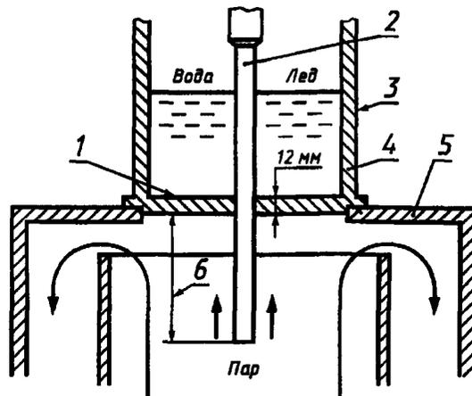
1 — скользящая прокладка для предотвращения утечки воды; 2 — ТС; 3 — контейнер; 4 — основание из пластика; 5 — гипсотермометр; 6 — глубина погружения
