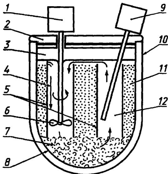
1 — двигатель мешалки; 2 — изолирующая крышка; 3 — металлическая сетка; 4 — направление водного потока; 5 — медная трубка; 6 — крыльчатка; 7 — маленькие кусочки льда; 8 — металлическая сетка; 9 — ТС; 10 — сосуд Дьюара на 5 л; 11 — мелкозернистый лед; 12 — вода при 0 °C
