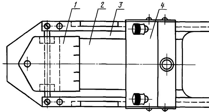
Образец помещают на планку лицевой поверхностью вниз и закрепляют одним концом пружинным зажимом. Для того чтобы конец образца не приклеивался к планке, он должен быть длиннее на 5 мм.
