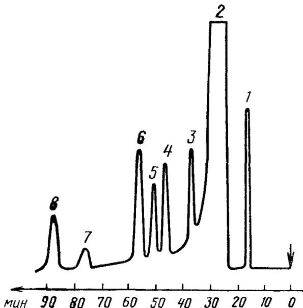
1 — метилхлорид; 2 — четыреххлористый углерод; 3 — хлороформ; 4 — трихлорэтилен; 5 — 1,2-дихлорэтан; 6 — хлористый амил; 7 — бромтрихлорметан; 8 — тетрахлорэтилен
