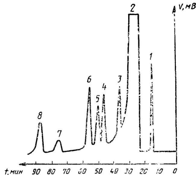
1 — метилхлорид; 2 — четырёххлористый углерод; 3 — хлороформ; 4 — трихлорэтилен; 5 — 1,2-дихлорэтан; 6 — хлористый амил; 7 — бромтрихлорметан; 8 — перхлорэтилен
