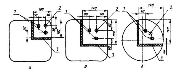
a — квадратная заготовка со стороной квадрата до 230 мм включительно;  $\delta$  — квадратная заготовка со стороной квадрата свыше 230 мм; e — круглая заготовка; I — два бруска для четырех образцов для испытания на ударную вязкость; 2 — образец для испытания на растяжение; 3 — автогенный рез
