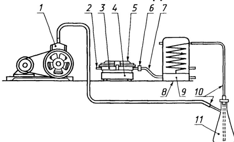
Допускается применение другого аппаратурного оформления схемы без изменения основных параметров возгонки ртути скорости эвакуации газов 6—10 дм<sup>3</sup>/мин, температуры возгонки 330—350 °С и прокаливания 490—510 °С
