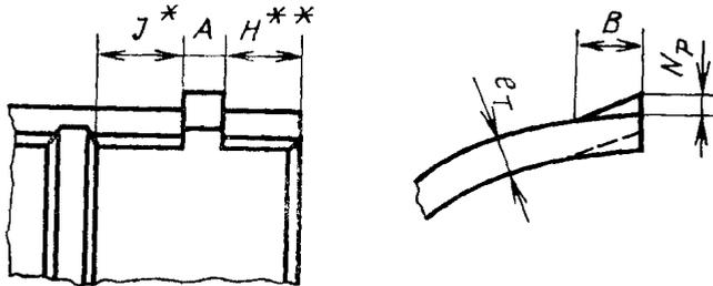
\* Выступ может входить в канавку, в этом случае  $J=0$ . В остальных случаях  $J \geq 2$  мм.
