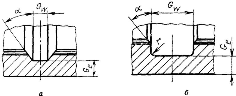
$r$ —радиус фаски (размер стандартом не устанавливается);  $G_w$ —ширина канавки (размер стандартом не устанавливается);  $G_E$ —толщина стенки под канавкой (размер стандартом не устанавливается)
