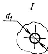
$d$  — номинальные диаметры резьбовых отверстий;  $d_1$  — номинальные диаметры крепежных отверстий;
