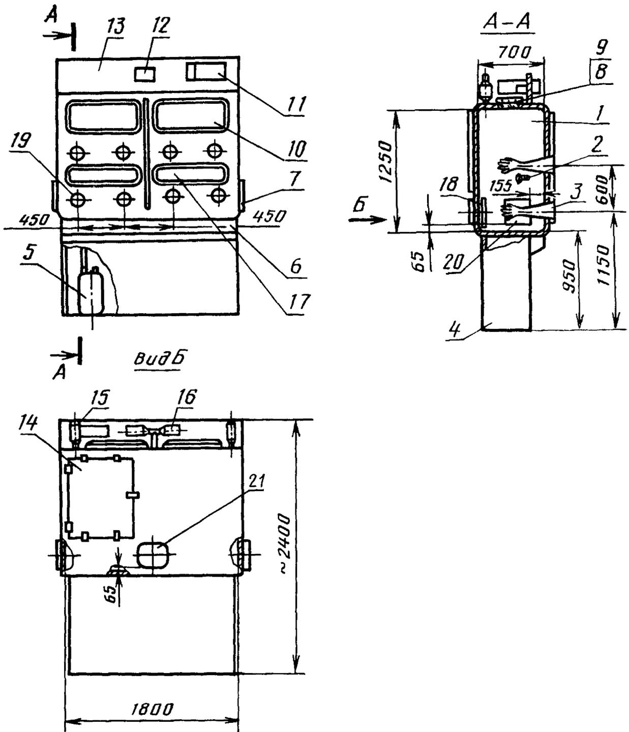
1—корпус; 2—душевик-распылитель; 3—перчатки; 4—подставка; 5—сборник жидких отходов; 6—вентильная панель; 7—заглушка люка; 8, 10, 17—окно по ГОСТ 23410; 9—светильник; 11—пульт управления; 12—тягонапоромер; 13—панель приборов; 14—монтажная дверь; 15—фильтр вытяжной; 16—фильтр приточный; 18—дверка люка; 19—обойма; 20—2 люка; 21—люк для транспорта
