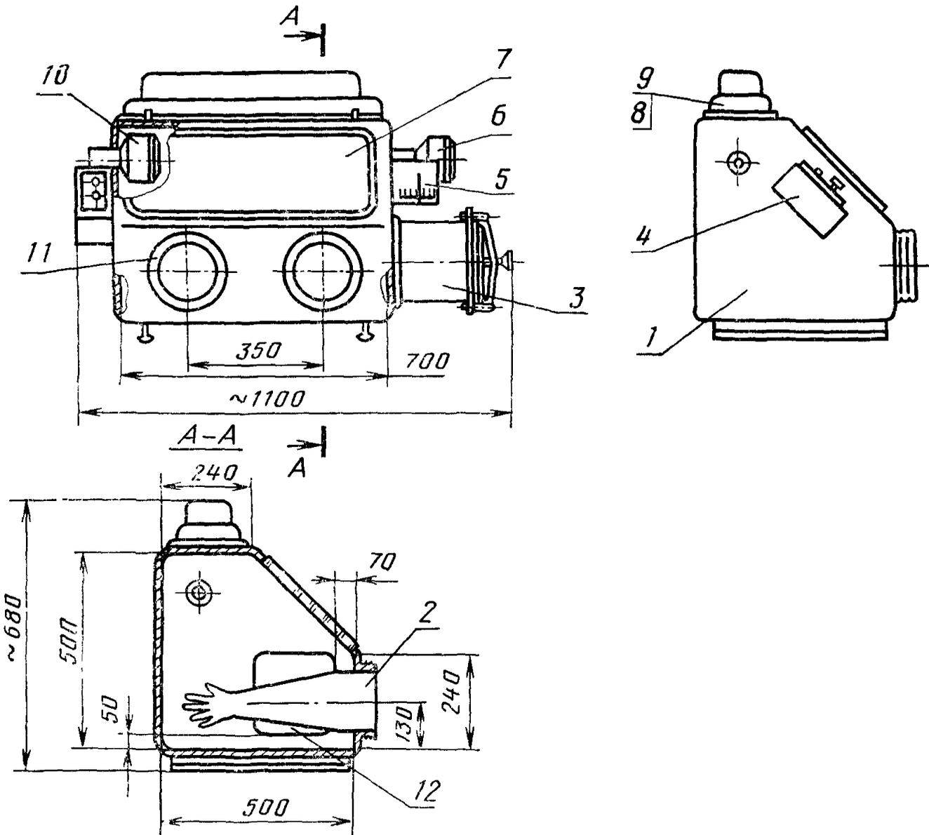
1—корпус; 2—перчатки; 3—шлюз; 4—пульт управления; 5—тягонапоромер; 6—фильтр приточный; 7, 9—окно по ГОСТ 23410; 8—светильник; 10—фильтр вытяжной; 11—обойма; 12—люк (КХЛ; D)
