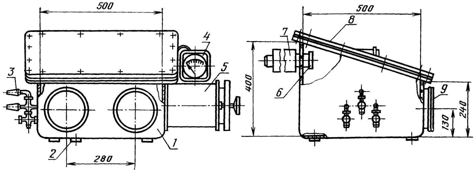
1 — корпус; 2 — узел слива; 3 — краны; 4 — тягонапоромер; 5 — шлюз; 6 — заслонка узла притока (вытяжки); 7 — фильтр приточный (вытяжной); 8 — корпус; 9 — обоймы для перчаток
