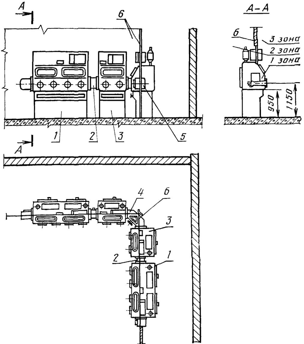
1—защитный бокс 1BP2; 2—шлюз промежуточный; 3—защитный бокс 1BP1; 4—шлюз промежуточный угловой; 5—шлюз; 6—зональная перегородка
