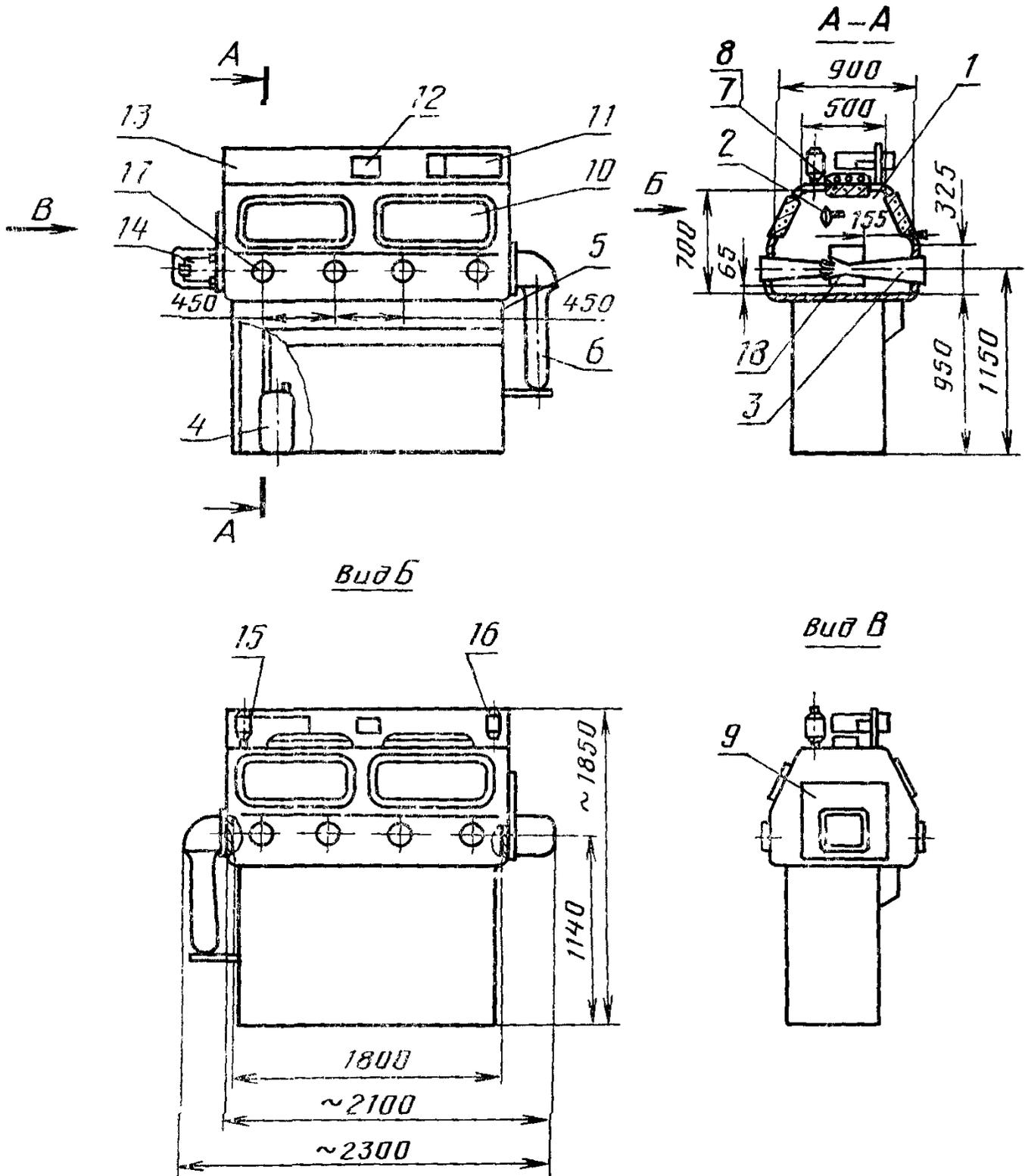
1—корпус; 2—душевик-распылитель; 3—перчатки; 4—сборник жидких отходов; 5—вентиляционная панель; 6—узел удаления твердых отходов; 7, 10—окно по ГОСТ 23410; 8—светильник, 9—монтажная дверь; 11—пульт управления; 12—тягонапоромер, 13—панель приборов, 14—шлюз, 15—фильтр вытяжной, 16—фильтр приточный, 17—обойма, 18—2 люка
