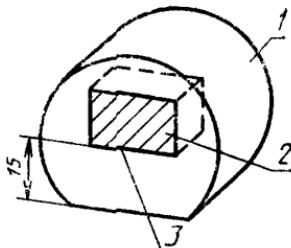
1—фенольная смола или эквивалентный ей материал, 2 — отшлифованная испытуемая поверхность, 3—образец
